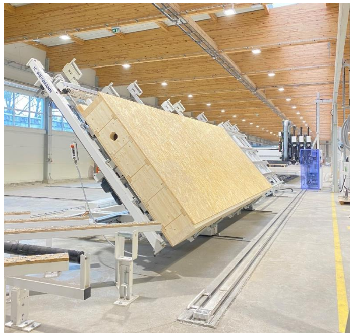
Fotografia 10 - Panel stropowy podczas podnoszenia na stole montażowym w zakładzie prefabrykacji. Źródło: materiały Andrewex Construction.
