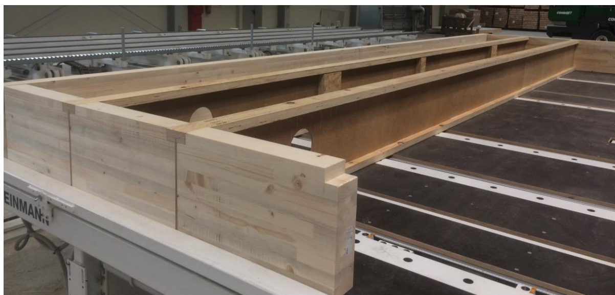
Fotografia 14 - Strop z dwuteowników z pasami z forniru klejonego warstwowo LVL i środnikiem z płyty wiórowej na stole montażowym. Źródło: materiały Andrewex Construction.
