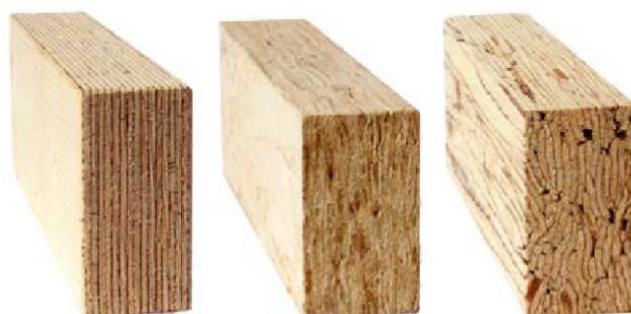
Fotografia 7 - Od lewej: fornir klejony warstwowo LVL, wióry z ciętego forniru ułożone wzdłużnie PSL, warstwowe wióry drzewne LSL [Green i in. 2017].
